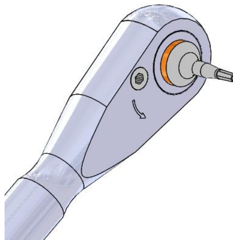
FIG.5 cacciavite-chiave dinamometrica montati
